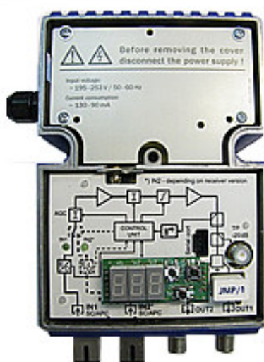
Рис. 5.1. Внутренний вид оптического приемника MOB-729 с модулем местного мониторинга C-729.
