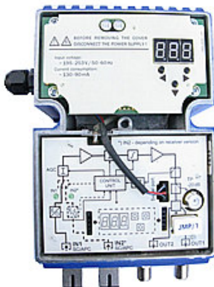
Рис. 5.2. Внутренняя часть оптического приемника MOB-729 с установленным на заводе модулем дистанционного мониторинга М-729.
