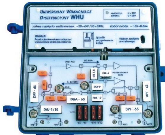
Универсальный распределительный усилитель **WHU-927** разработан для сетей кабельного ТВ (CATV) в качестве «узла мощности».
